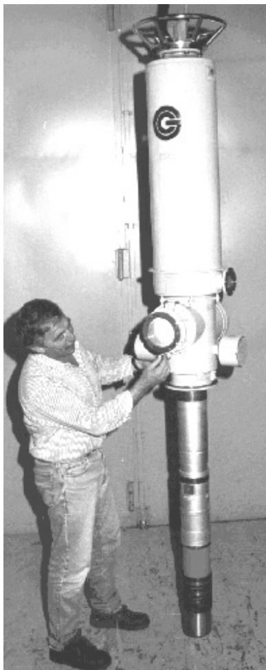
Рис. 3.63. Внешний вид гиротрона, выдающего 600 кВт мощности электромагнитного излучения на частоте 140 ГГц
